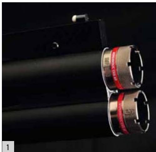
1. Le volate con il mirino tipo Bradley M3 di colore bianco e gli strozzatori Exis hp (hyperbolic profile), realizzati nello stesso acciaio e con il medesimo procedimento delle canne Tribore hp. La spina è deputata al fissaggio della bindella.
